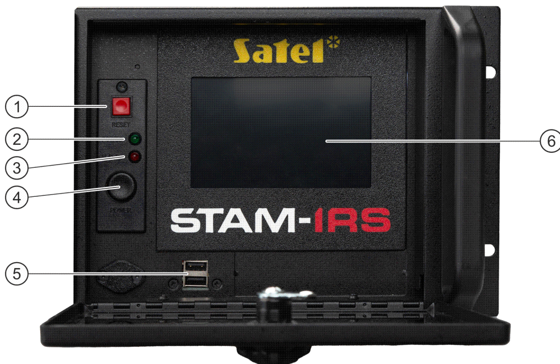
Rys. 2. Wyświetlacz TFT LCD wraz z panelem przycisków funkcyjnych.
